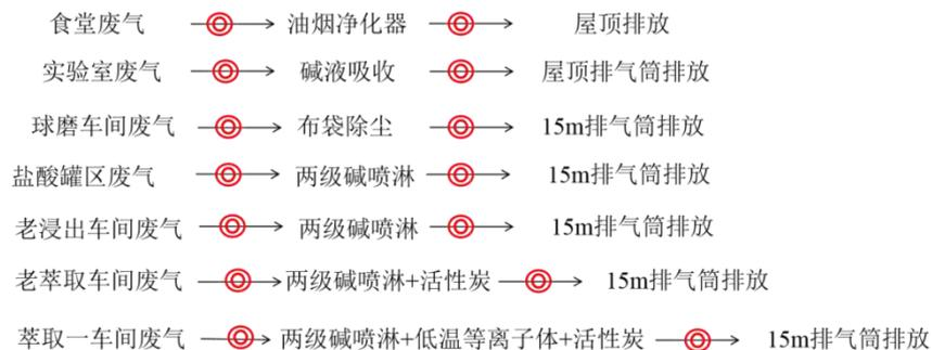
图 7-2 有组织废气采样点位示意图
