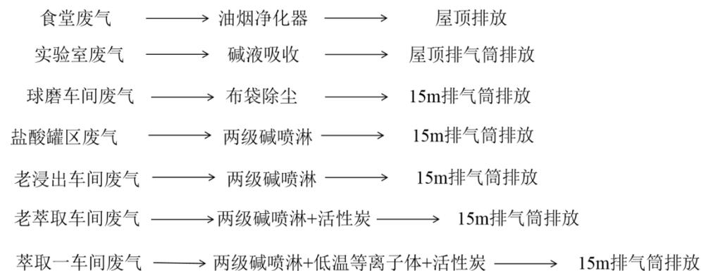
图 4-4 废气治理工艺流程图
