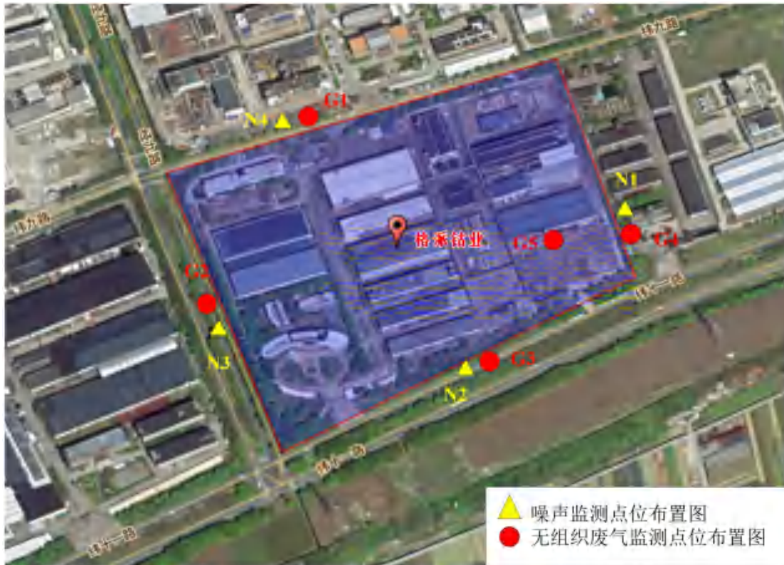
图 7.3-1 厂界无组织废气监测点位及厂界噪声监测点位图
